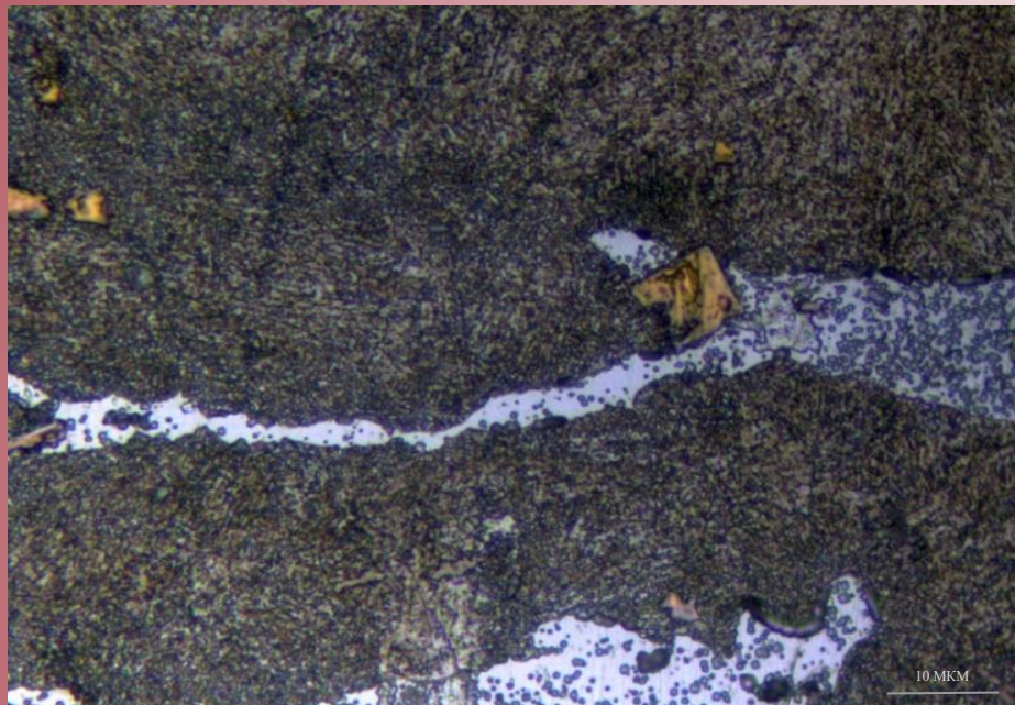
Рисунок 1-Микротруктура блюма из стали 08X17H6T(ДИ 21) в состоянии поставки.
