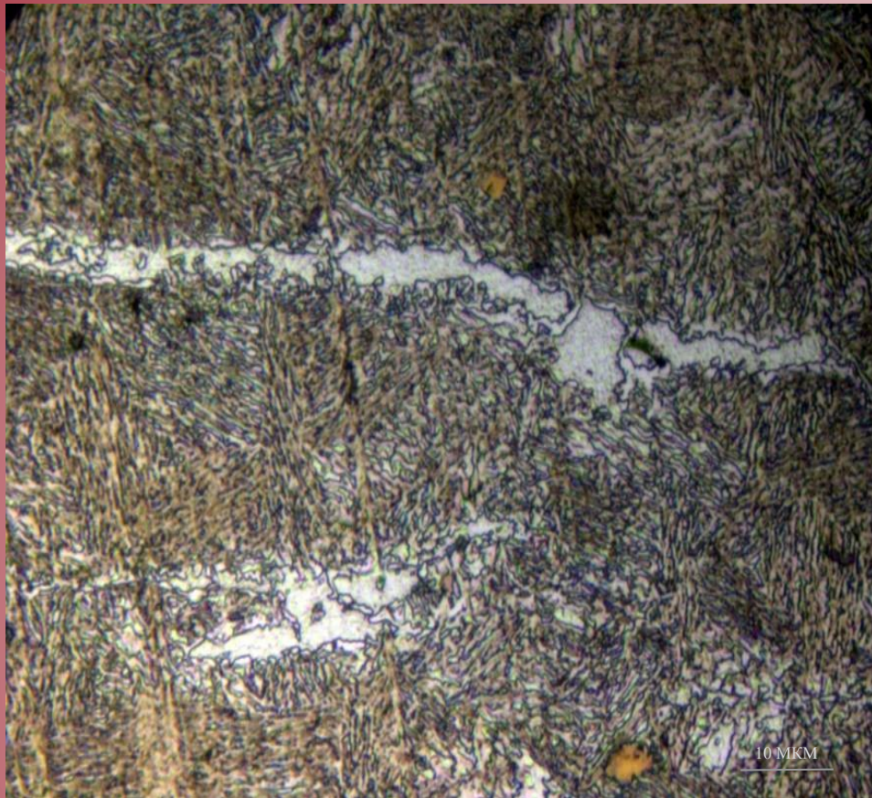
Рисунок 4-Микроструктура стали после закалки 1040°C и отпуска 550°.
