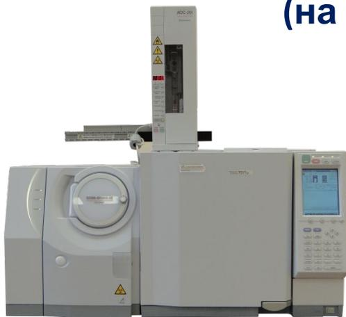
Газовый хромато-масс-спектрометр, Shimadzu Япония
