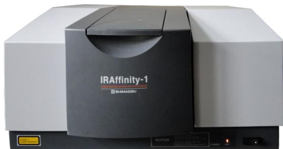
Инфракрасный спектрометр с преобразованием Фурье IRAffinity-1, Shimadzu Япония
