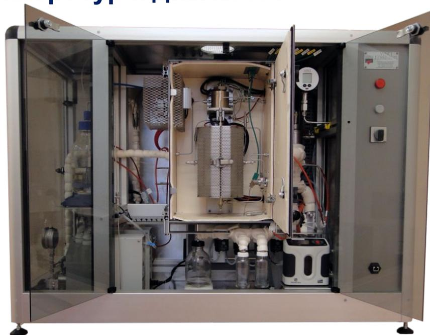
Установка для тестирования катализаторов переработки углеводородного сырья (нефтепереработки, нефтехимии, газохимии)
