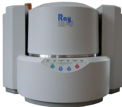
Энергодисперсионный рентгенофлуоресцентный спектрометр, Shimadzu Япония
