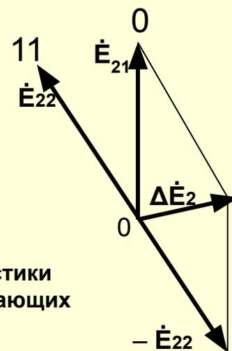
Векторная диаграмма вторичных линейных ЭДС параллельно работающих трехфазных трансформаторов 0 и 11 групп соединения обмоток
