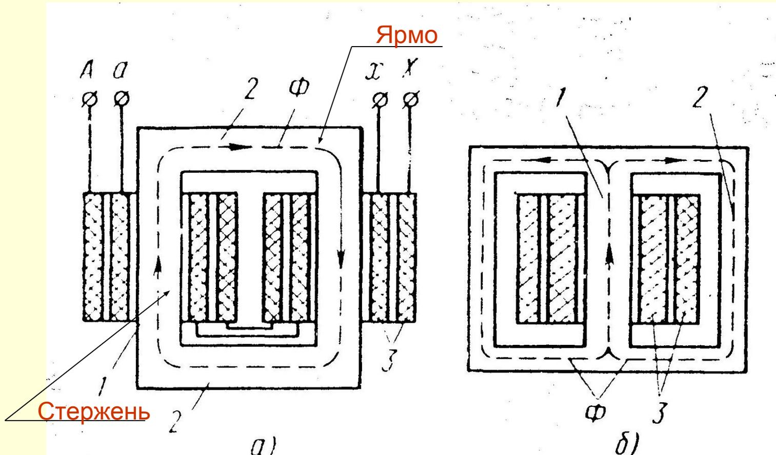
Трансформатор состоит из магнитопровода, набранного из листов электротехнической стали толщиной 0,35...0,5 мм, и обмотки, выполненной из медного или алюминиевого провода. Различают **первичную обмотку** (подключается к источнику питания) и **вторичную** (подключается к нагрузке).
