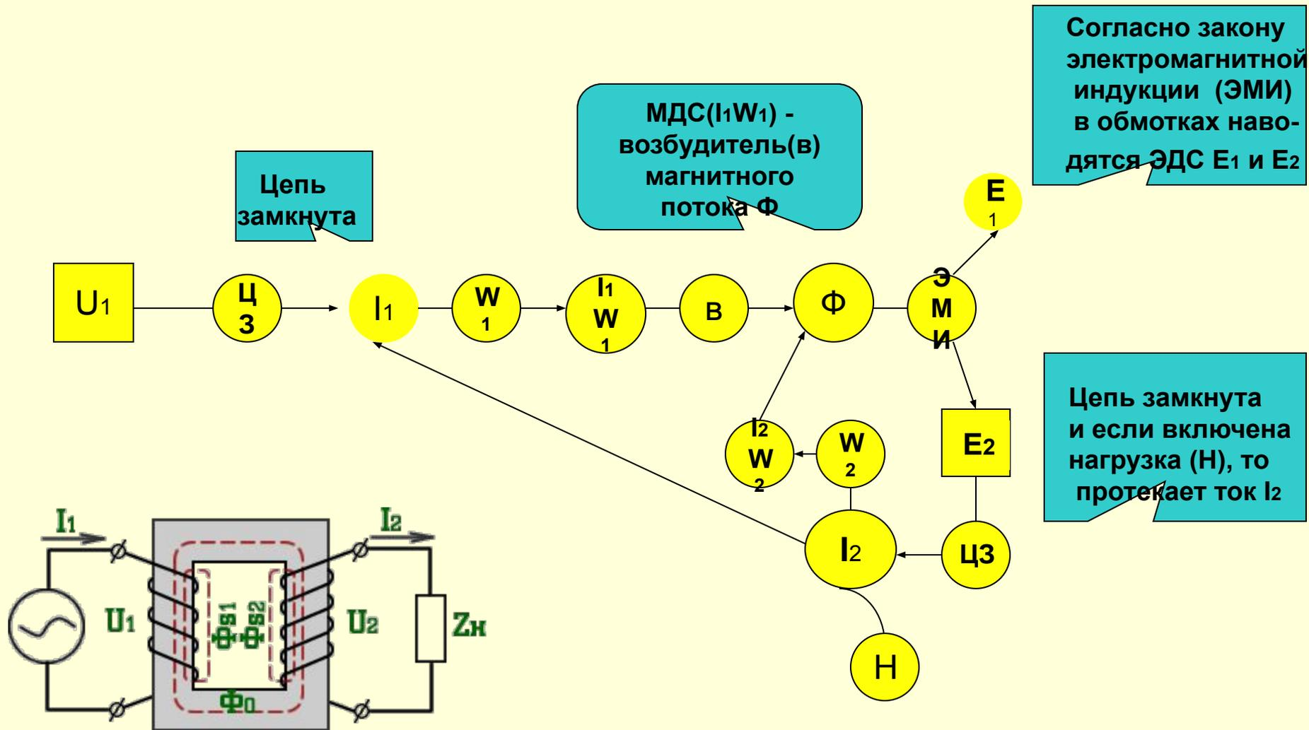
Рабочий поток  $\Phi$  по закону электромагнитной индукции наводит в первичной обмотке ЭДС самоиндукции  $e_1$  и во вторичной обмотке ЭДС взаимной индукции  $e_2$ :
