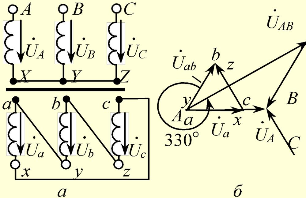
У трехфазных трансформаторов угол сдвига этих напряжений кратен  $30^\circ$ , что делает возможным 12 групп соединений, которые нумеруют целыми числами 0, 1, 2.....11.
