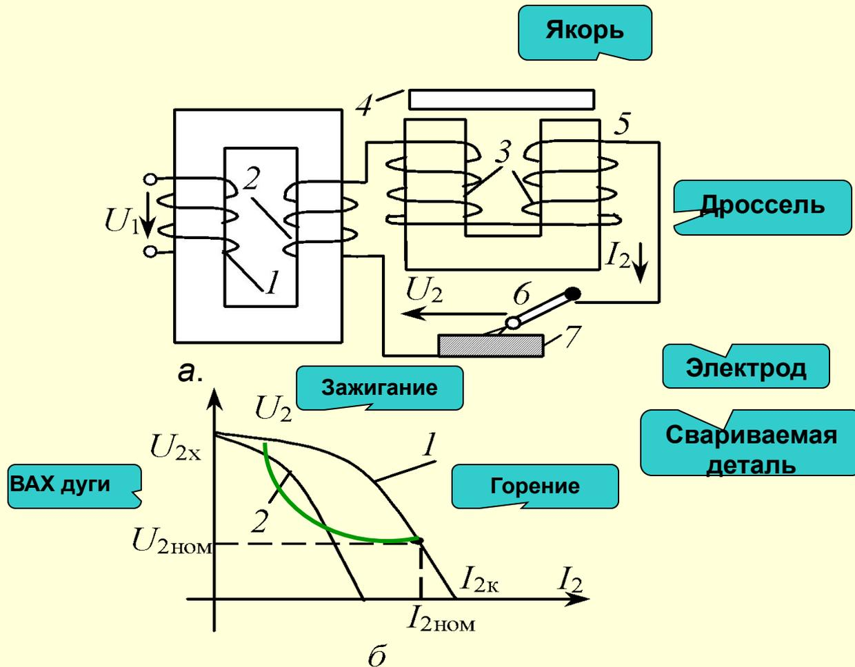
Устройство сварочного трансформатора (а):
