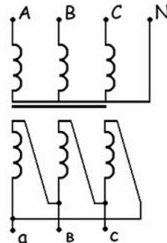
Начала и концы обмоток ВН обозначают буквами А, В, С и Х, Y, Z, а НН – а, b, с и х, у, z. Эти обмотки могут быть соединены звездой «Y» или треугольником «Δ».
