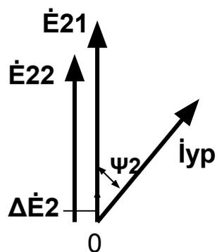
Векторная диаграмма вторичных ЭДС и уравнительного тока параллельно работающих однофазных трансформаторов
