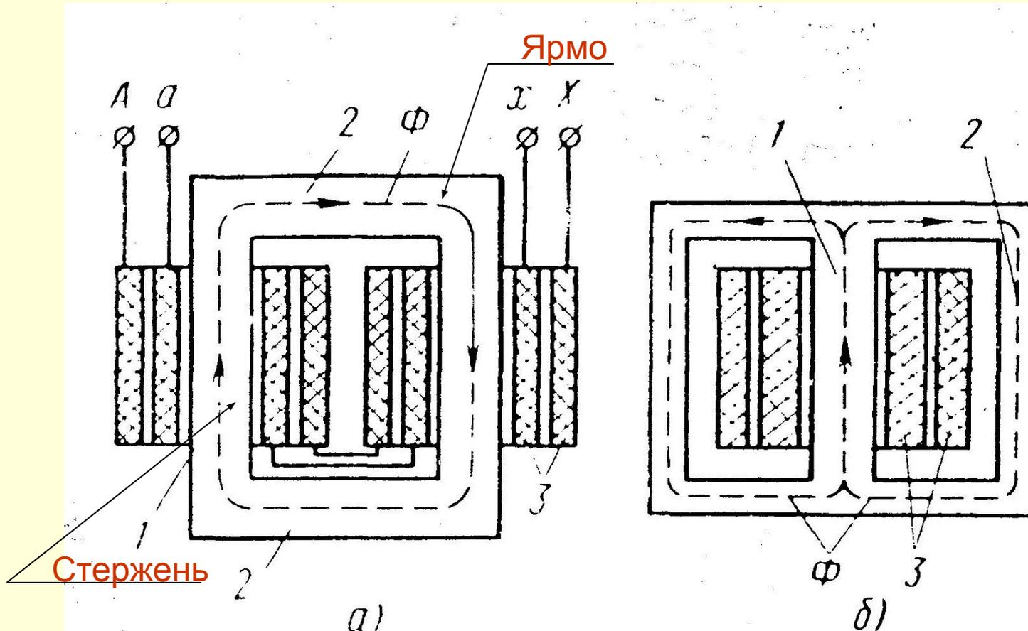
Трансформатор состоит из магнитопровода, набранного из листов электротехнической стали толщиной 0,35...0,5 мм, и обмотки, выполненной из медного или алюминиевого провода. Различают **первичную обмотку** (подключается к источнику питания) и **вторичную** (подключается к нагрузке).
