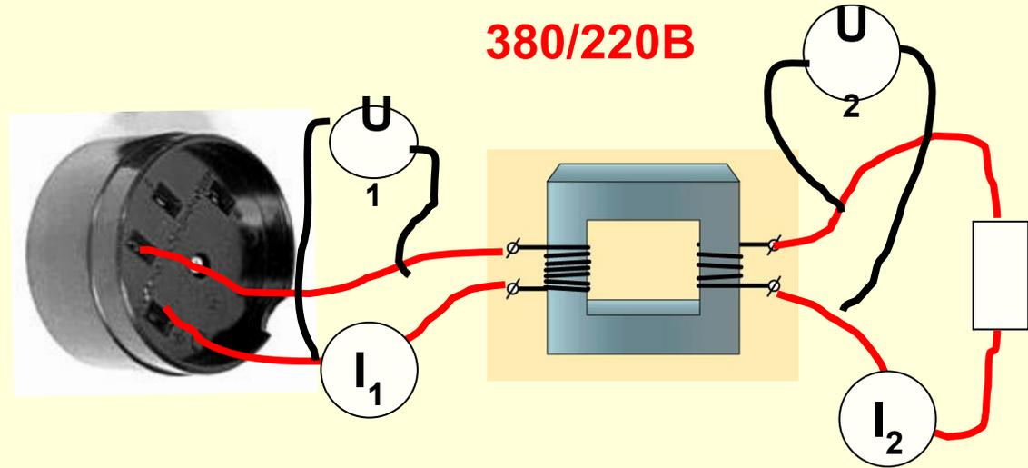
Если напряжение  $U_2 < U_1$  ( $w_1 > w_2$ ), то трансформатор называется **понижающим**. В противном случае трансформатор называется **повышающим** ( $k < 1$ ). В соответствии с этим различают обмотку высшего **ВН** и обмотку низшего **НН** напряжения.
