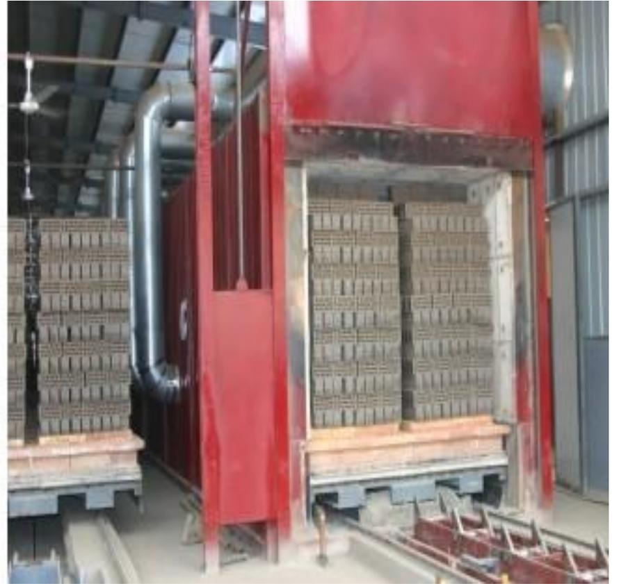
Длина туннельных печей колеблется от 5 до 150 м, ширина (внутри) — от 1,5 до 3 м и высота от пода вагонетки до замка свода 1,6—1,8 м от головки рельсов до замка свода 2,5 до 2,8 м.
