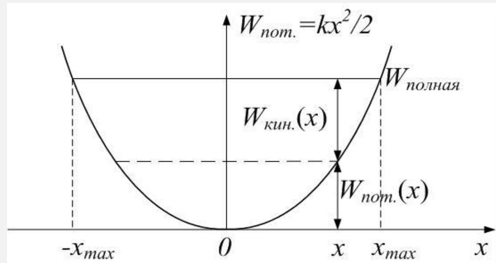
$$W_{\text{ном.}} = \frac{kx^2}{2} \quad \Rightarrow \quad F_{\text{упр.}} = -\frac{dW_{\text{ном.}}}{dx} = -kx$$
