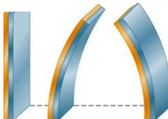
В металлических термометрах используются биметаллические пластинки: две пластинки из разных металлов, соединенные между собой. Коэффициент линейного расширения металлов разный, поэтому при нагревании и охлаждении пластинки изгибаются, через передаточный механизм это передается стрелке прибора.
