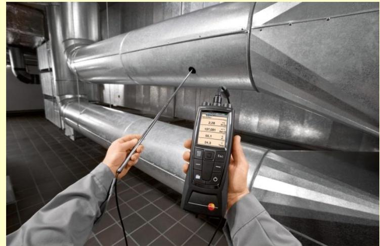
испытания, определяющие эффективность работы установок системы воздушного отопления и приточной вентиляции и соответствие их паспортным и проектным данным
