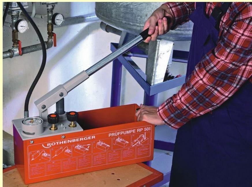
**Температура воды не более  $70^{\circ}\text{C}$**
