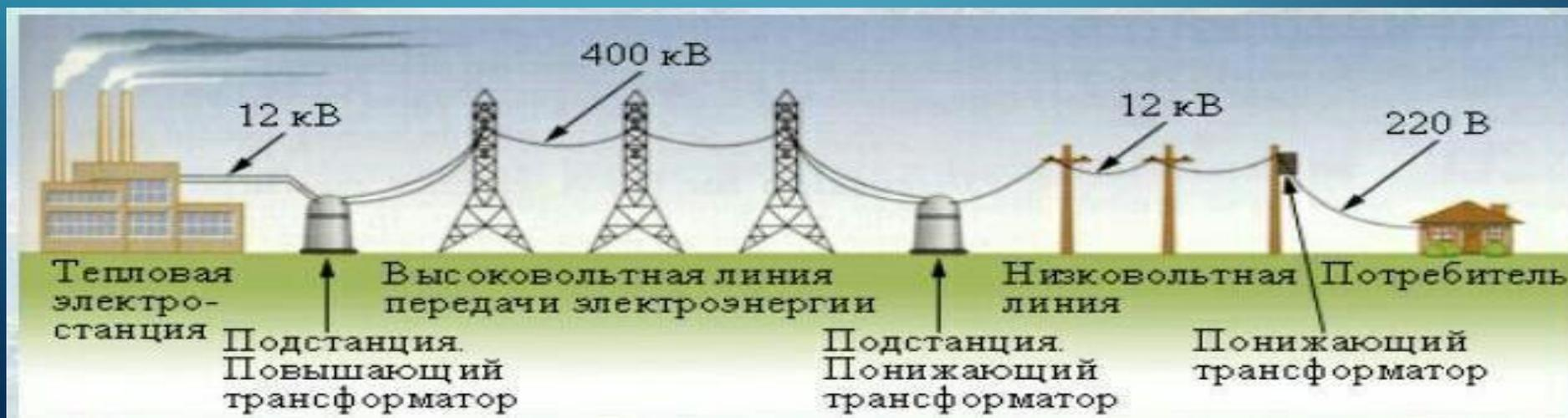
Трансформаторы широко используются в промышленности и быту для различных целей. 1. Для передачи и распределения электрической энергии. Обычно на электростанциях генераторы переменного тока вырабатывают электрическую энергию при напряжении 6-24 кВ, а передавать электроэнергию на дальние расстояния выгодно при значительно больших напряжениях (110, 220, 330, 400, 500, и 750 кВ). Поэтому на каждой электростанции устанавливают трансформаторы, осуществляющие повышение напряжения.
