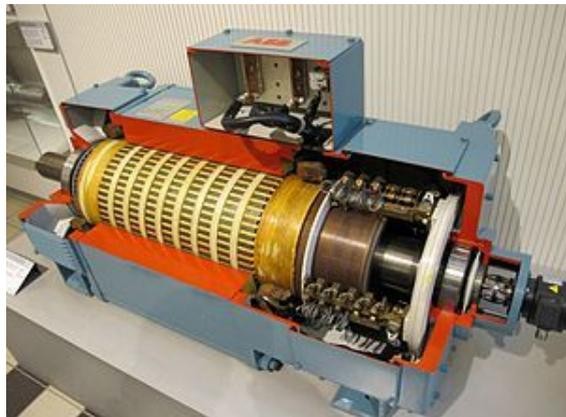
Электрический двигатель (электромеханический преобразователь) – электрическая энергия преобразуется в механическую. В основу работы любой электрической машины положен принцип электромагнитной индукции. Электрическая машина состоит из неподвижной части – статора или индуктора (для машин постоянного тока) и подвижной части – ротора или якоря (для машин постоянного тока).
