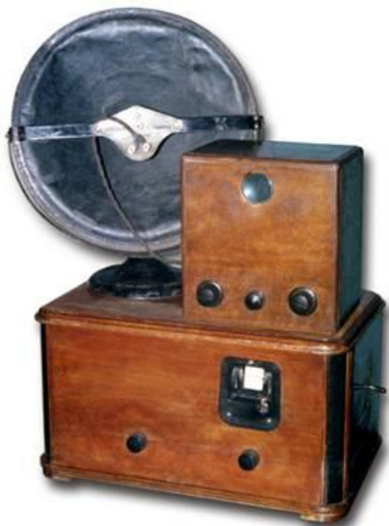
Телевизор с механической разверткой (СССР, 1932 г.)
