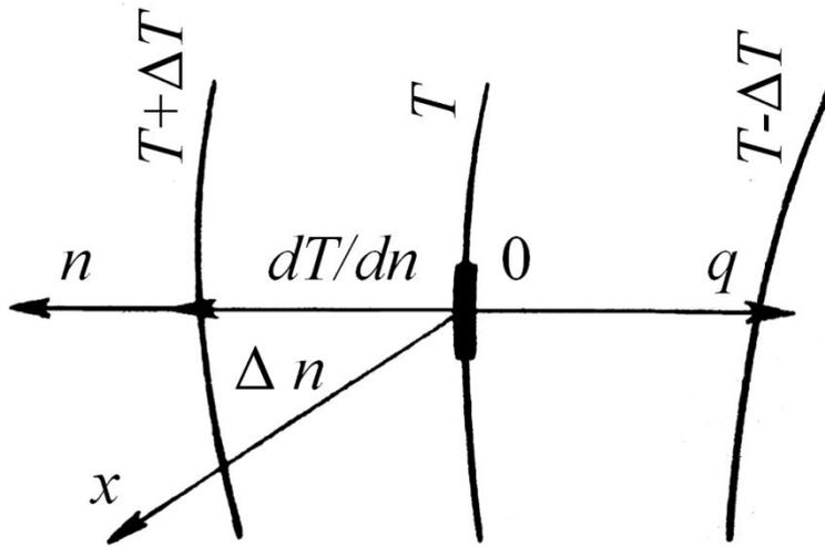
Рис. 1. Изменение температуры в теле (закон Фурье)
