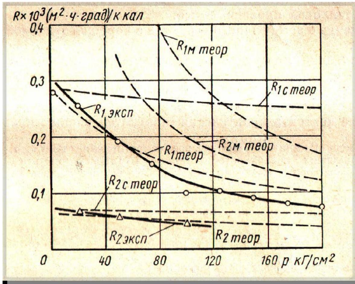
Рис. 9. Сопротивление фактического контакта в зависимости от нагрузки
