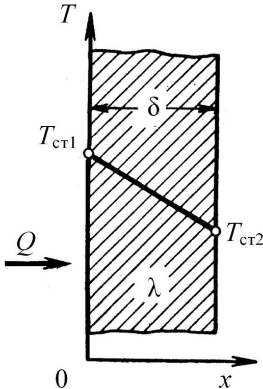
Рис. 2. Теплопроводность в однослойной плоской стенке
