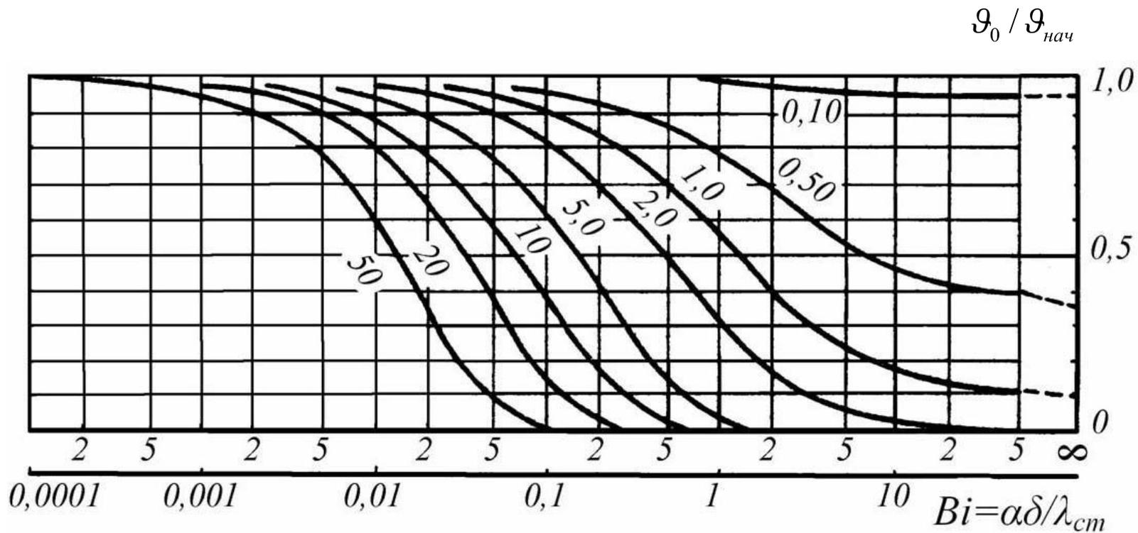
Рис. 7. Зависимости  $\frac{g_0}{g_{нач}} = f(Bi, Fo)$  для плоской стенки
