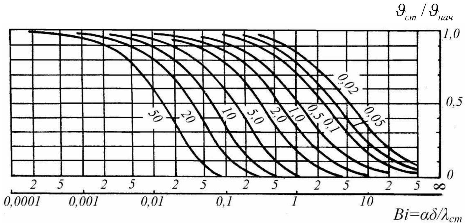
Рис. 6. Зависимости  $\frac{\vartheta_{ст}}{\vartheta_{нач}} = f(Bi, Fo)$  для плоской стенки
