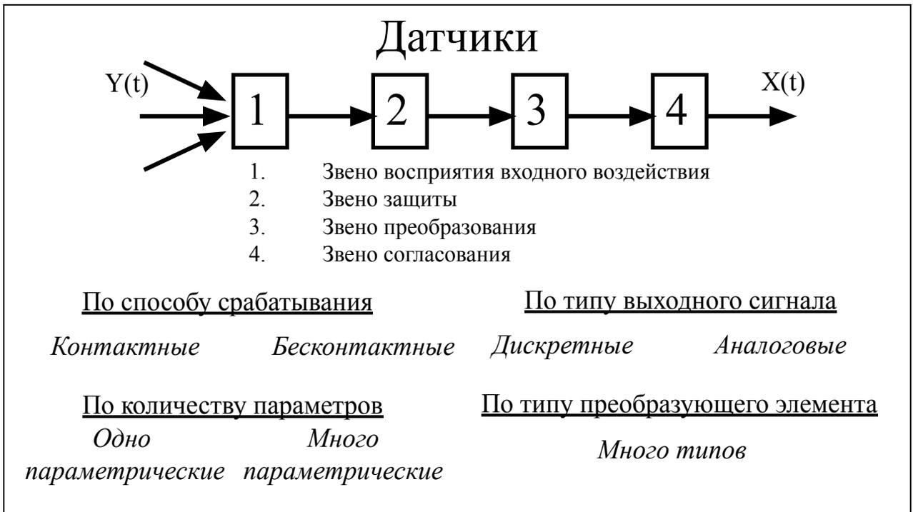
**Датчик** – самостоятельное, конструктивно – автономное средство измерения, размещаемое в месте отбора информации и исполняющее функцию преобразования измеряемой физической величины в электрический сигнал, состоящее из минимально необходимых звеньев преобразования, и обладающее взаимосвязанными метрологическими и надежными характеристиками.
