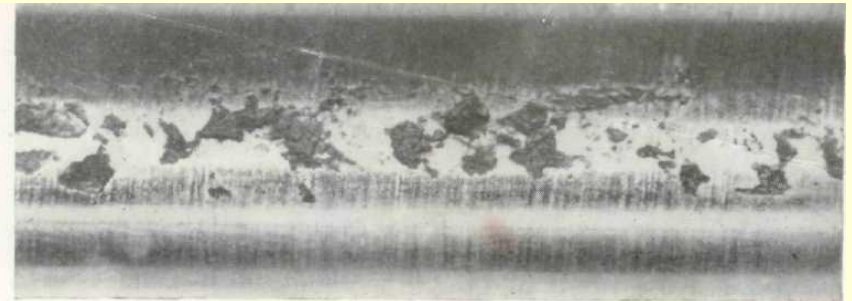
Рис. 159. Изъявленная поверхность обточенного прутка
