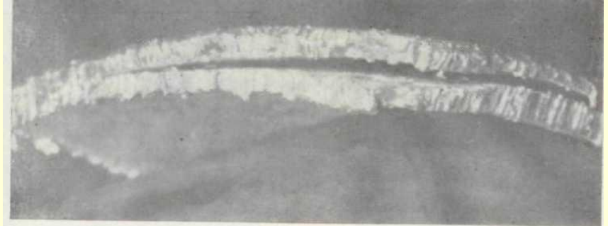
Рис. 117. Расслоение в толстом листе
