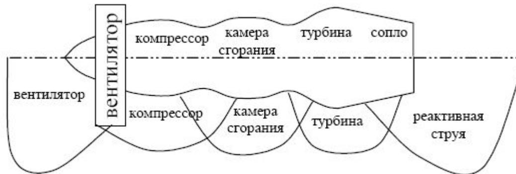
Распространение шума через конструкцию в стороны от двигателя связано с частичным отражением и поглощением звуковых волн элементами конструкции (корпусом двигателя, вторым контуром, мотогондолой).
