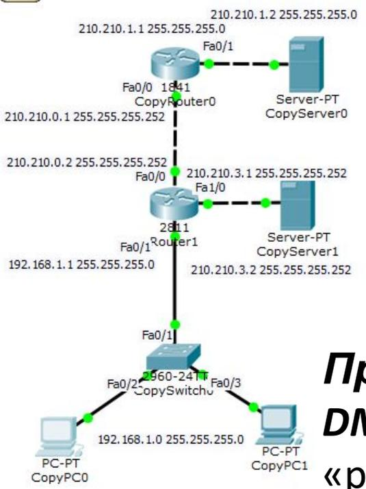
**Проверим связь компьютеров с DMZ-сервером: «ping 210.210.3.2».**
