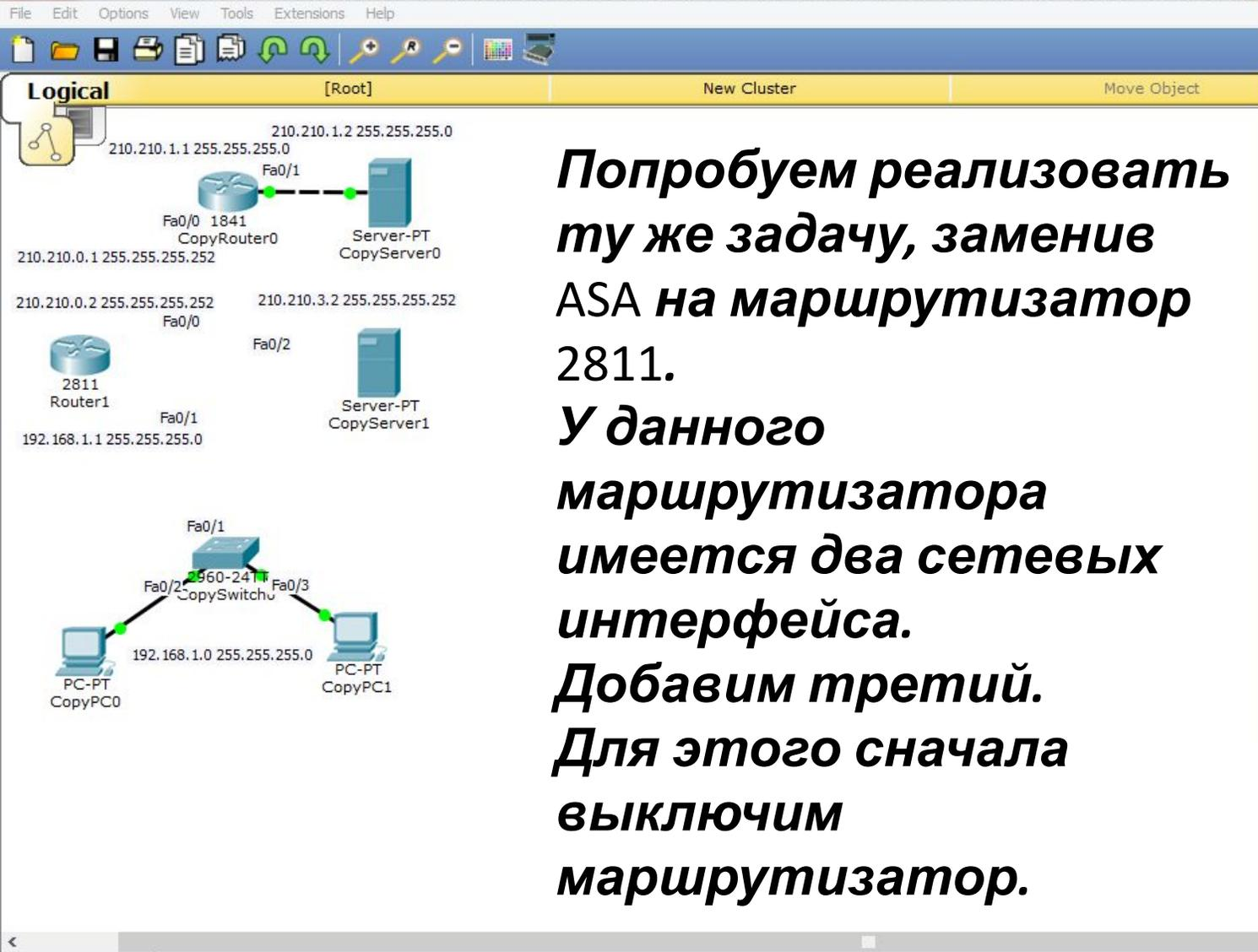
**Попробуем реализовать ту же задачу, заменив ASA на маршрутизатор 2811. У данного маршрутизатора имеется два сетевых интерфейса. Добавим третий. Для этого сначала выключим маршрутизатор.**
