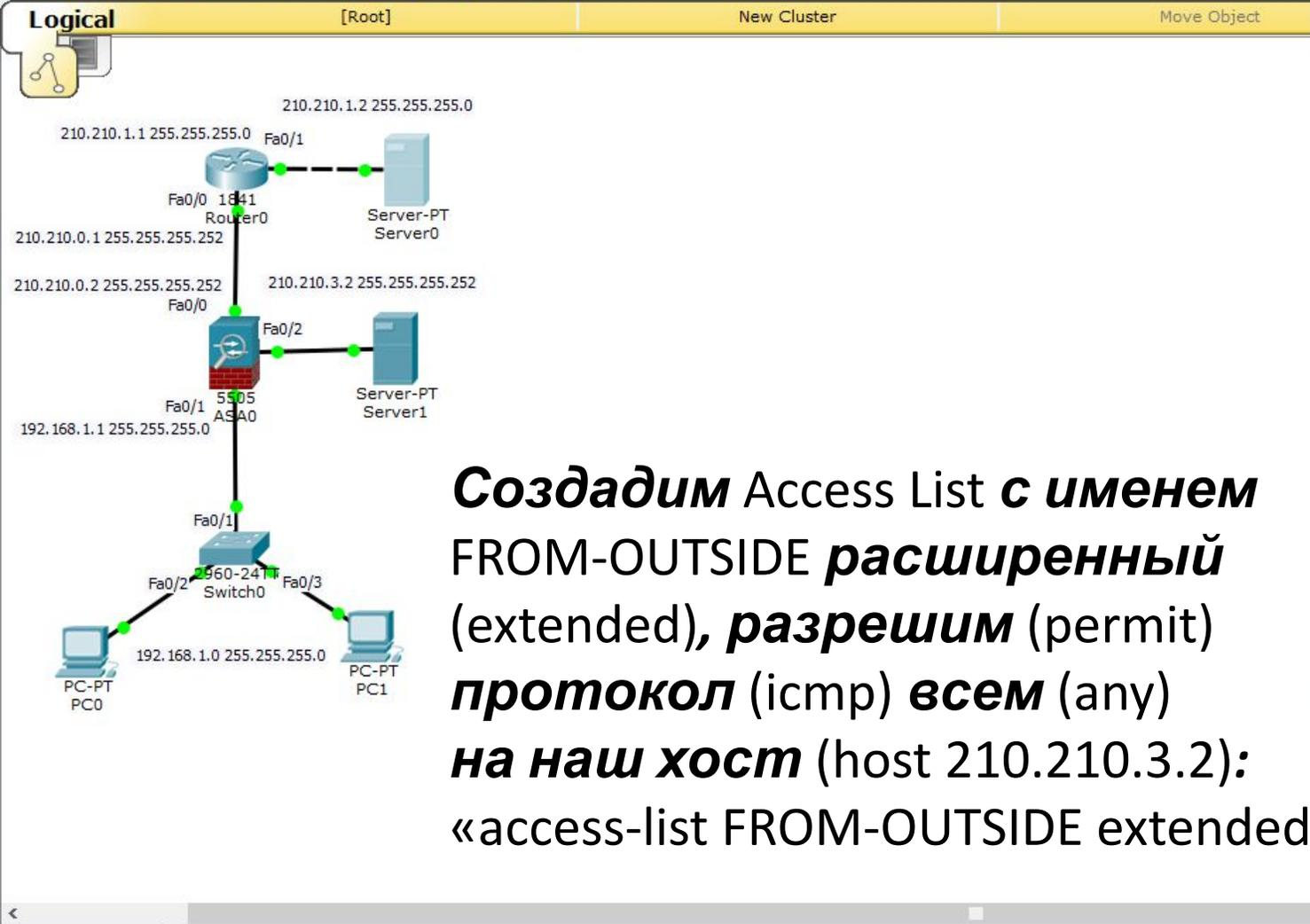
**Создадим Access List с именем FROM-OUTSIDE расширенный (extended), разрешим (permit) протокол (icmp) всем (any) на наш хост (host 210.210.3.2):**
