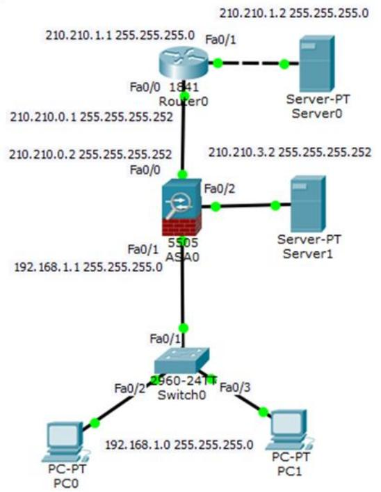
Соберём небольшую сеть, подобную той, что создавали на прошлом занятии, состоящую из двух компьютеров и межсетевого экрана 5505. Сеть Интернет, как обычно будем эмулировать с помощью маршрутизатора 1841 и сервера.
