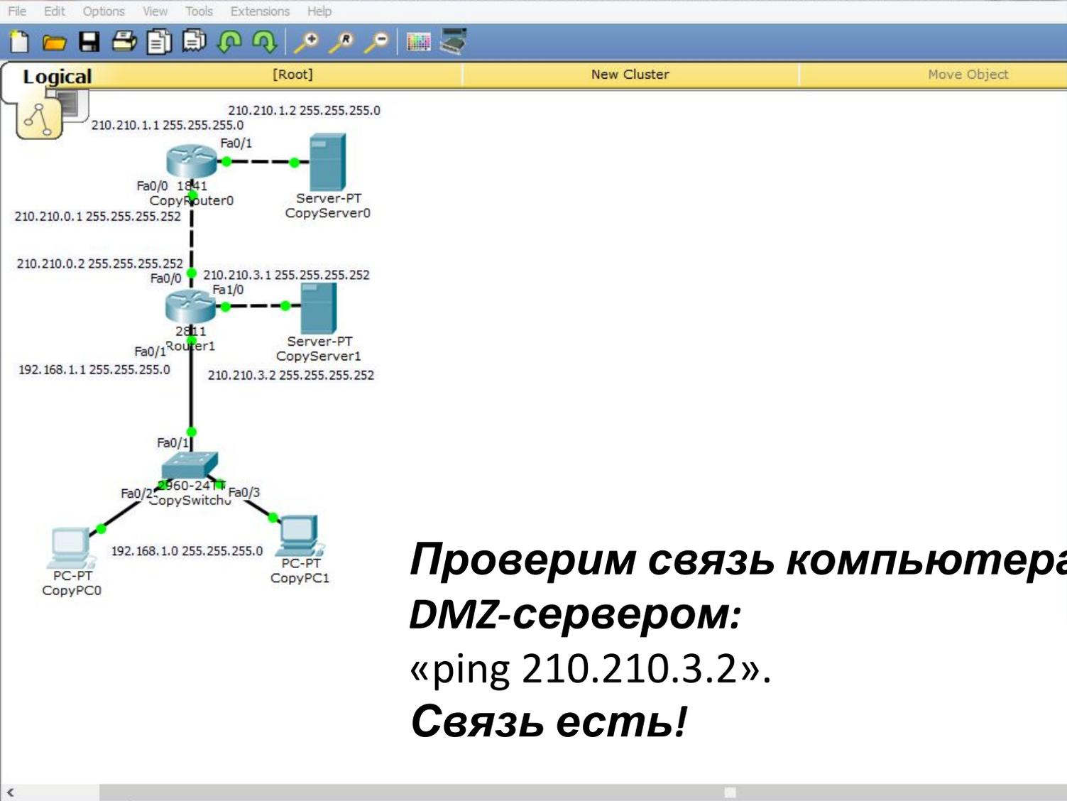
**Проверим связь компьютера с DMZ-сервером:
