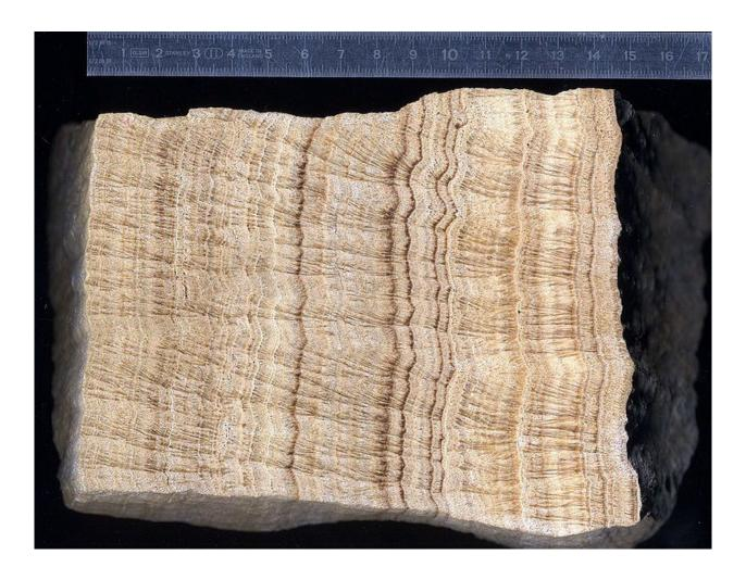
Тонкая, гофрированная слоистость в известняке из кладки Римского акведука. Скорость напластования известняков in situ была равна 1 мм/год. Над образцом приведена сантиметровая линейка
