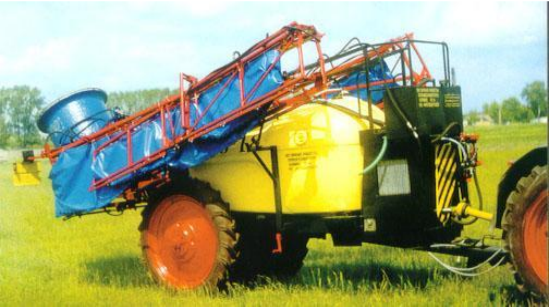
Прицепной штанговый опрыскиватель с воздушным сопровождением
