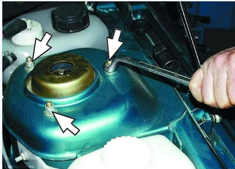
Накидным ключом на 13 отворачиваем гайки крепления верхней опоры.
