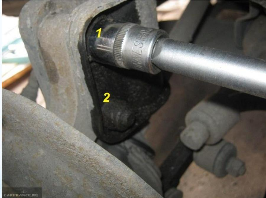
Отворачиваем головкой на 19 гайки болтов, затем выбиваем их.
