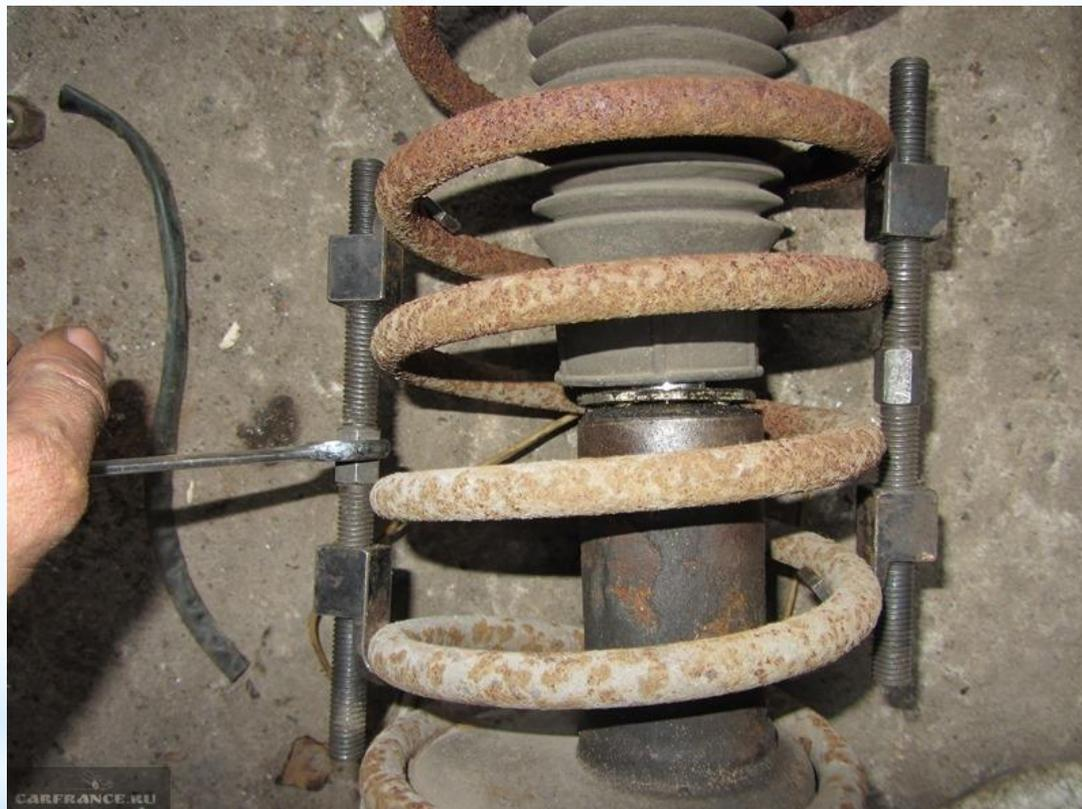
Для сжатия пружин использовать специальные стяжки
