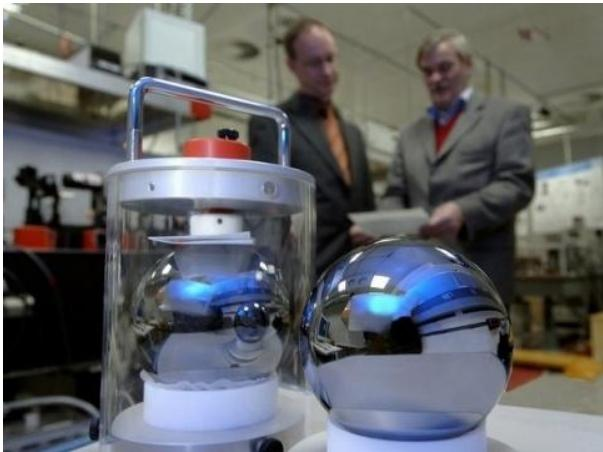
Возможный преемник эталона килограмма - шар из определенного числа изотопов кремния-28
