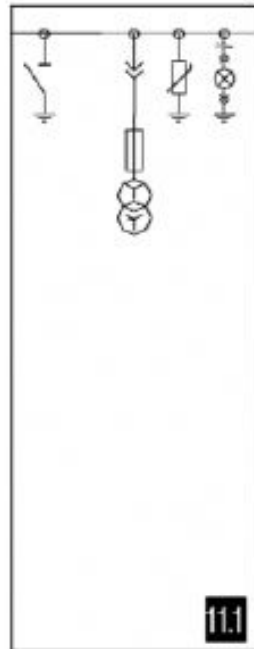
Шкаф с шинным заземляющим разъединителем и измерительным тр-ром
