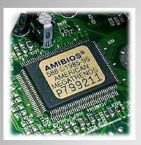
ВІОЅ (Basic Input-Output System - базовая система ввода-вывода) – это программа, прошитая в постоянное запоминающее устройство (ПЗУ). В нашем случае ПЗУ встроено в материнскую плату, однако своя версия ВІОЅ присутствует почти во всех элементах ЭВМ (в видеокарте, в сетевой карте, дисковых контроллерах и т.д.), да и вообще почти во всем электронном оборудовании (и в принтере, и в видеокамере, и в модеме, и т.д.).
