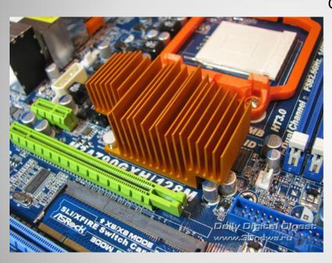
Северный мост, как следует из его названия, выполняет функции контроля и направления потока данных из 4-х шин:
