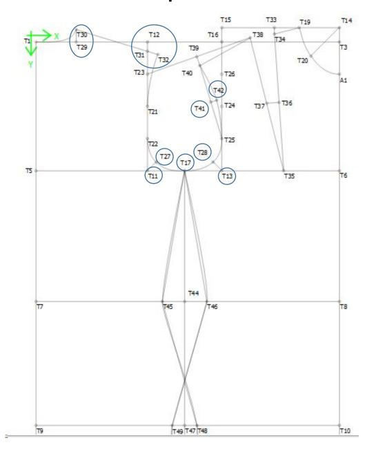
Точка Т41 делит линию Т40-Т25 пополам Т41-Т42 = 1 см, перпендикуляр к линии Т40-Т25 Т13-Т28 = 2-2,5 см, биссектриса угла Т25-Т13-Т17 (точка Т17 делит линию Т13-Т11 пополам)
