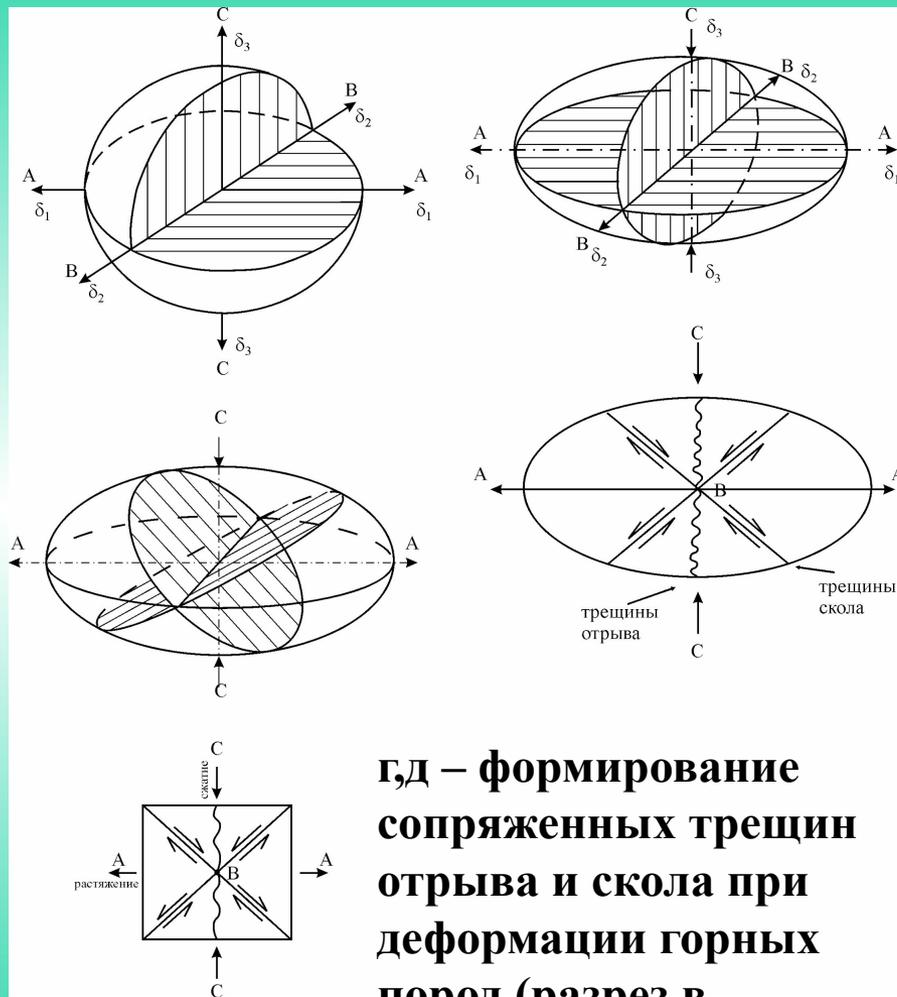
г,д – формирование сопряженных трещин отрыва и скола при деформации горных пород (разрез в плоскости осей А-С)
