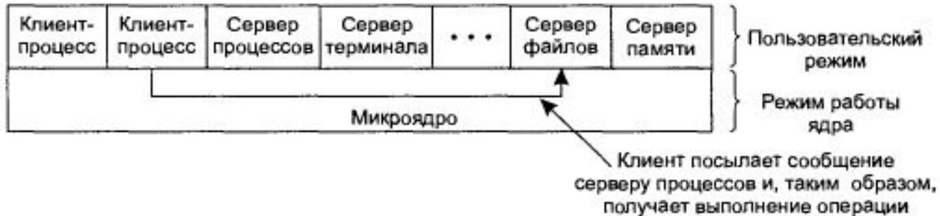
В данной модели, в задачу ядра входит только управление связью между клиентами и серверами. Благодаря разделению операционной системы на части, каждая из которых управляет всего одним элементом системы, все части становятся маленькими и управляемыми. К тому же, поскольку все серверы работают как процессы в режиме пользователя, а не в режиме ядра, они не имеют прямого доступа к оборудованию.
