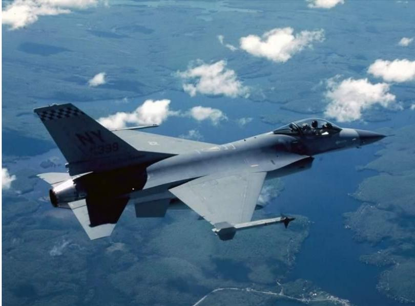
F-16 оснащен импульсным доплеровским радиолокатором, он позволяет видеть воздушные цели на расстоянии до 37 км в нижней полусфере, и до 46 км – в верхней. Истребитель оснащен ЭДСУ (Электродистанционная система управления) постоянного действия (что является одним из признаков самолетов четвертого поколения), РЛС предупреждения, бортовая ЭВМ, которая анализирует воздушную обстановку.
