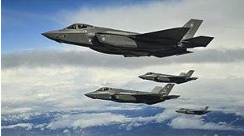
Семейство малозаметных многофункциональных истребителей-бомбардировщиков пятого поколения, разработанное американской фирмой Lockheed Martin в трёх вариантах: наземный истребитель для нужд ВВС США, истребитель с укороченным взлётом и вертикальной посадкой для Корпуса морской пехоты США и ВМС Великобритании, и палубный истребитель для нужд ВМС США.
