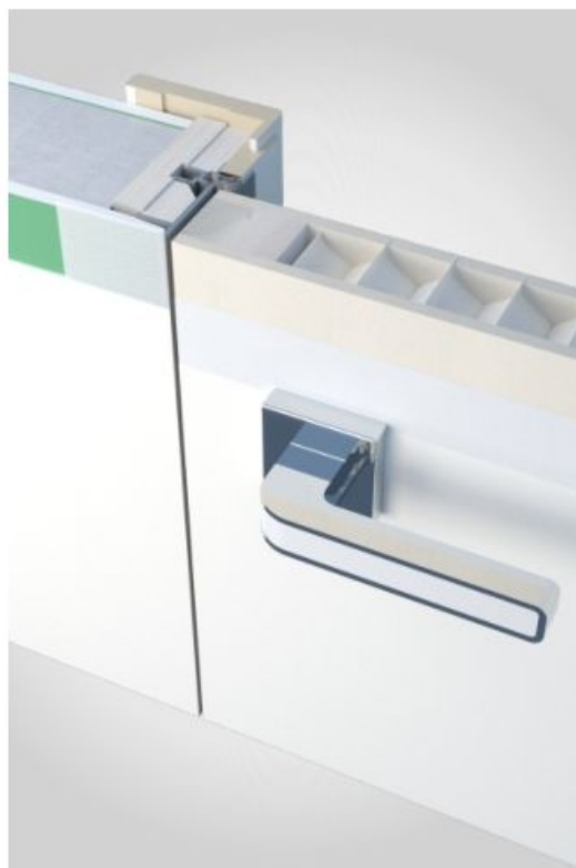
Стена с гипсокартоном с двух сторон. Короб INVISIBLE, портал тип 1/100 телескоп (подрезанный), наличник «Телескоп». Толщина стены от 86 до 150 мм.
