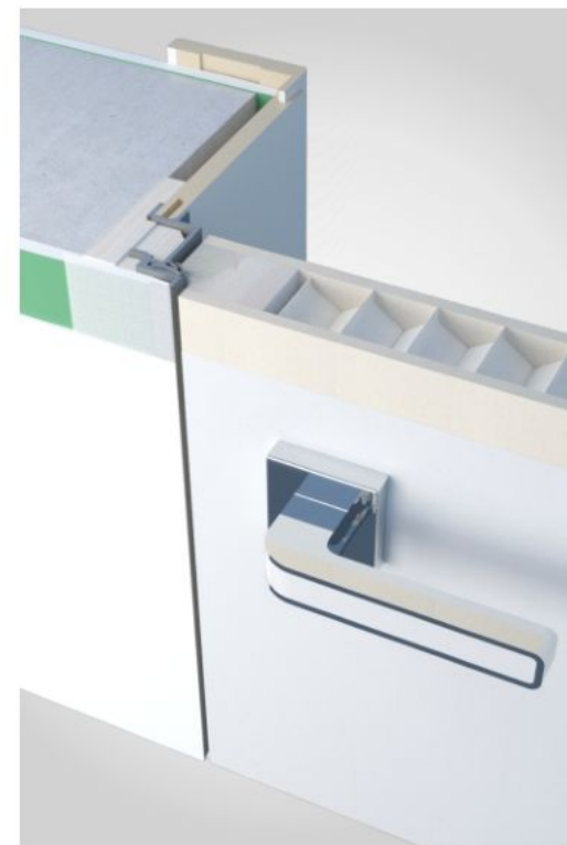
Стена с гипсокартоном с двух сторон. Короб INVISIBLE REVERSE, портал тип 1/100 телескоп, наличник «Телескоп». Толщина стены от 86 до 146 мм.
