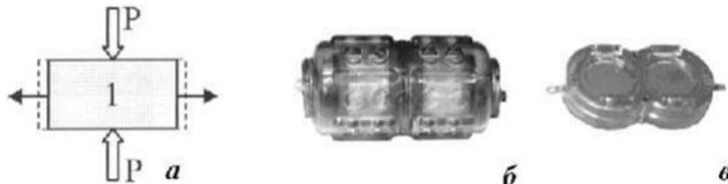
а – принципиальная схема; б – работающий на сжатие (ПДС-21); в – реагирующие на изгиб (ПДС-7)
