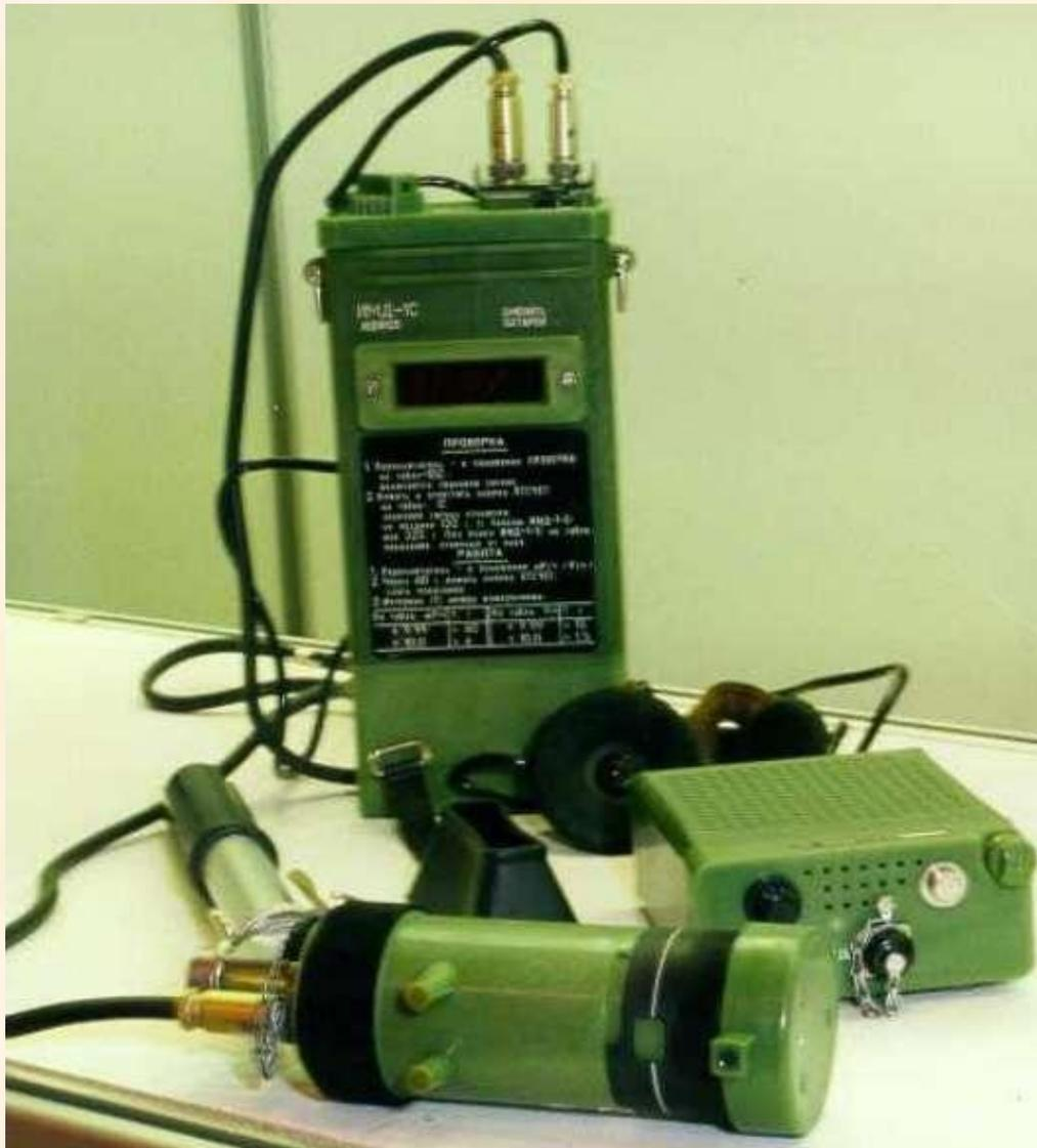
Предназначен для измерения в полевых условиях, при рассеянном дневном свете и в темноте мощности экспозиционной дозы гамма-излучения и обнаружения бета-излучения.
