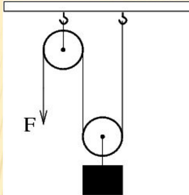
Неподвижный блок не даёт выигрыша в силе. А применяется для удобства. Он изменяет направление действия силы, например, позволяет поднимать груз, стоя на земле.
