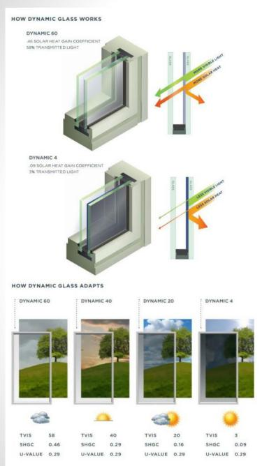
Калифорнийская компания View представила прототи стекла, которое изменяет свой цвет в зависимости от величины подаваемого на него электрического напряжения
