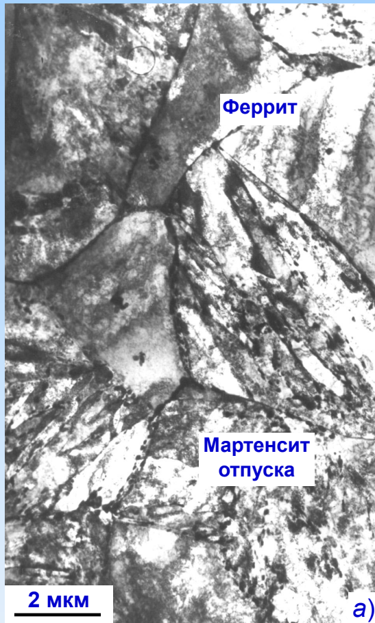
а) после штатной обработки (закалка от 1050 °С + отпуск 720 °С, 1 ч)
