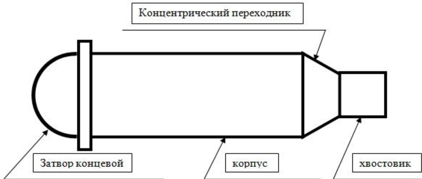
**Камеры запуска или приема имеют корпус, хвостовик, соединенный с корпусом через концентрический переходник, затвор концевой.**
