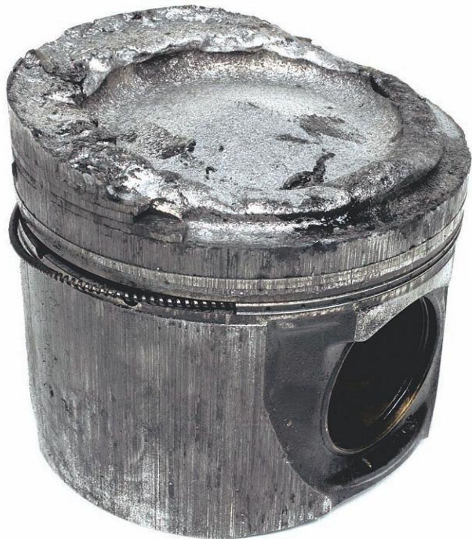
Рис. 2 Расплавленная головка поршня дизельного двигателя
