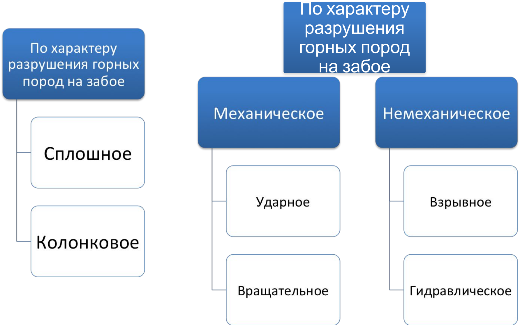
Схема 1. Классификация способов бурения на нефть и газ
