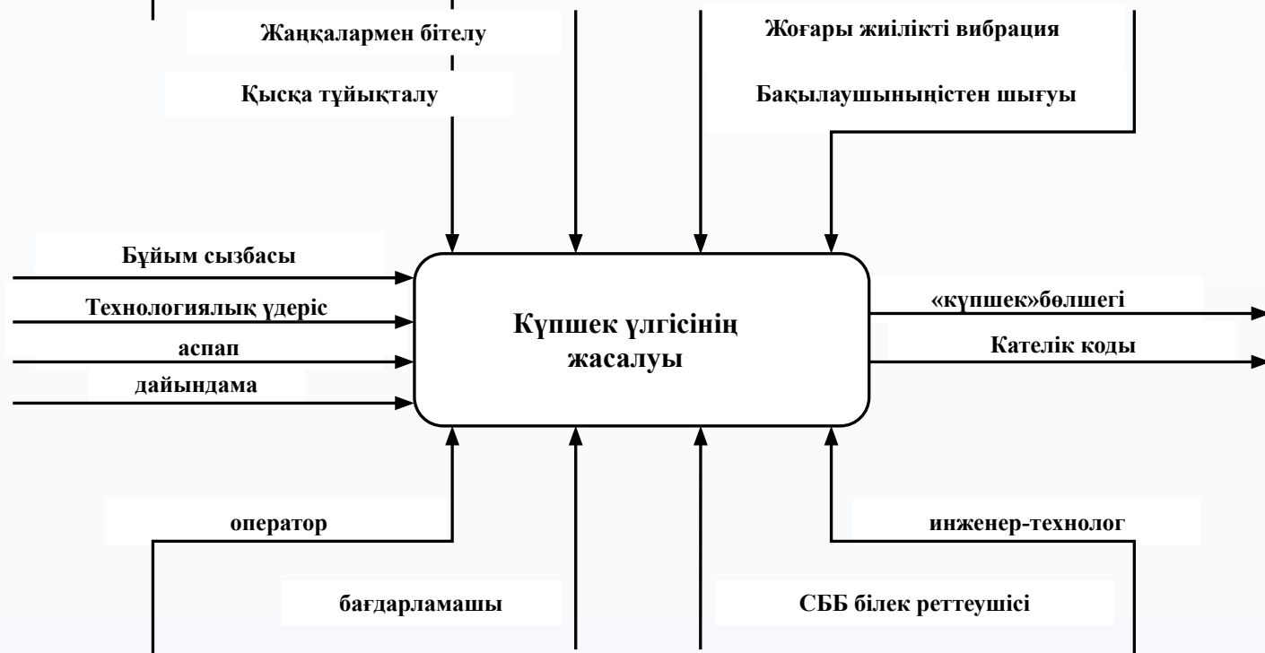
1.6 – сурет. «Күпшек» бөлшегінің станоктарда өңделуін дайындау жүйесінің функциональды үлгісі
