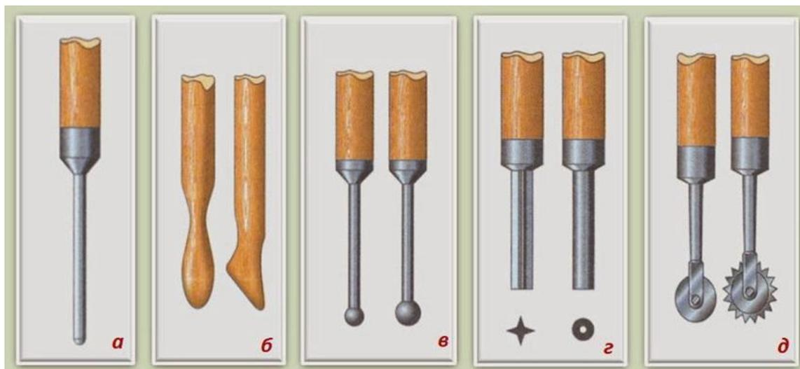
**Давилки** разных размеров для выдавливания крупных участков рельефа изготавливают из твёрдой древесины дуба, бука, яблони, клёна (рис. б). Деревянные давилки шлифуют и полируют, а рабочие части инструмента натирают парафином или воском, чтобы они легко скользили по фольге.
