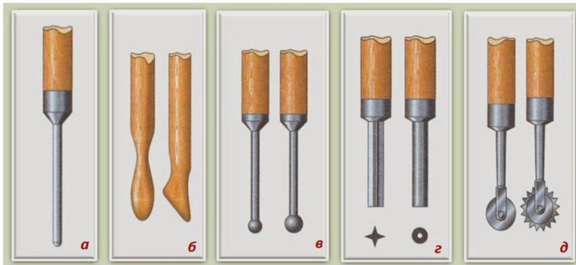
**Повторяющийся рельефный орнамент** в виде крестика, звёздочки, кружочка можно получить с помощью **штампиков**. Для изготовления штампа на торце деревянного или металлического стержня рисуют нужную фигуру, а затем опиливают её по контуру напильником и надфилями (рис. г).
