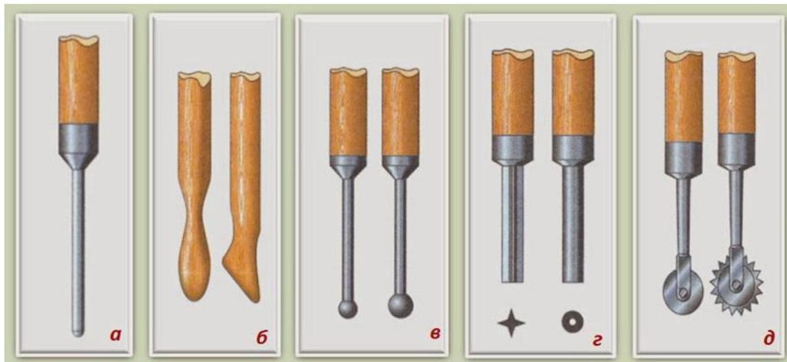
**Для выдавливания сплошных или пунктирных линий** используют накатки (рис. д), состоящие из ручки, стержня и вращающегося колёсика (гладкого или зубчатого).
