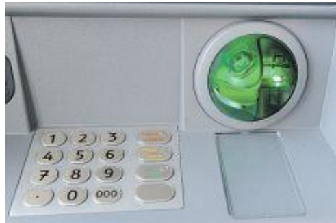
Фальш-накладка для считывания магнитной полосы карты
