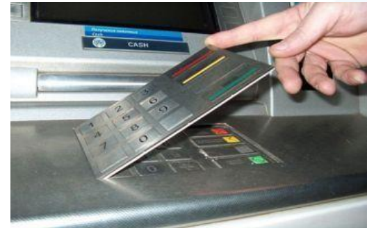
Накладная клавиатура для считывания ПИН-кода карты
