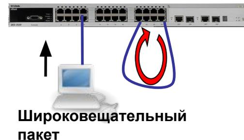
**Примечание:** Коммутаторы в этих примерах являются устройствами L2, VLAN на них не настроены, и протокол Spanning Tree не включен.
