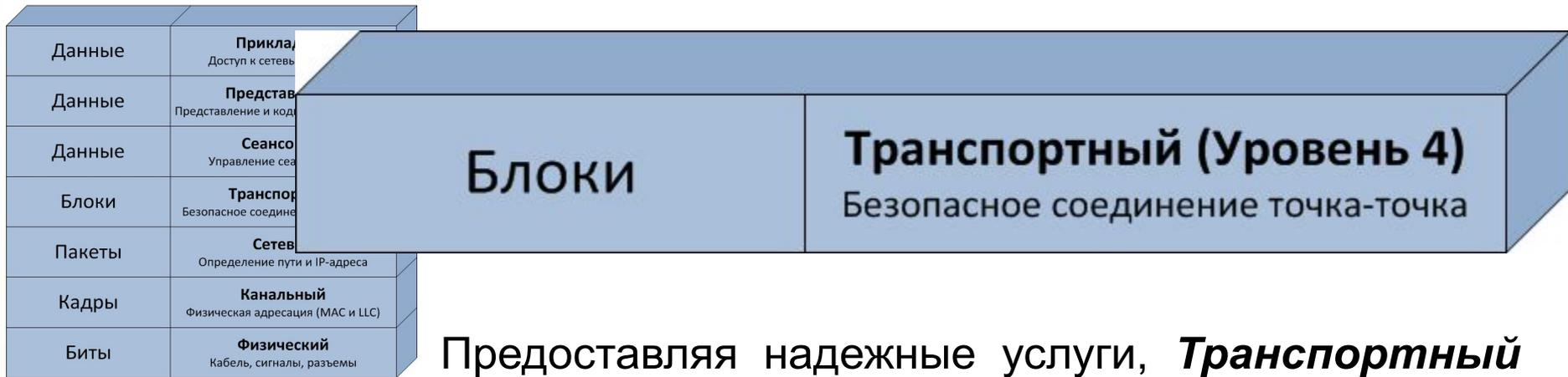
Предоставляя надежные услуги, **Транспортный уровень** обеспечивает механизмы для установки, поддержания и упорядоченного завершения действия виртуальных каналов, обнаружения и устранения неисправностей транспортировки, а также управления информационным потоком (с целью предотвращения переполнения одной системы данными от другой системы).
