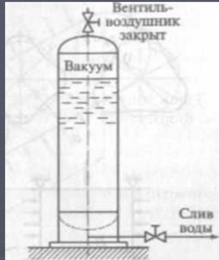
▶ **Длинные** цилиндрические обечайки и трубы теряют устойчивость с образованием двух волн смятия, аналогично ранее рассмотренным кольцам жесткости.
