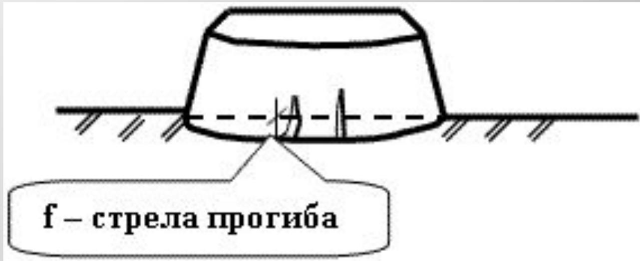
Деформация сооружения в виде прогиба с возможным развитием трещин
