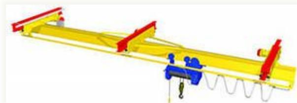
кран балки двух пролётные
