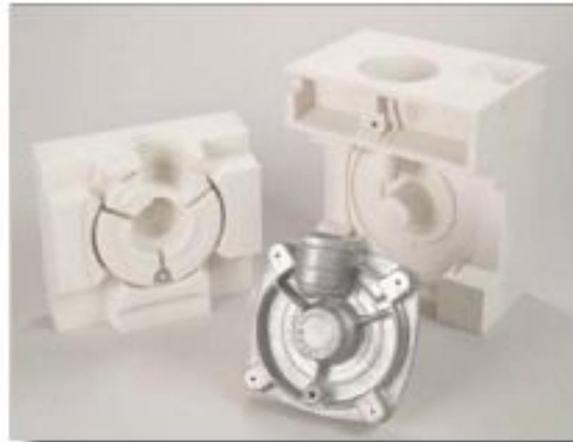
**Литейной формой** называется комплекс элементов, образующих замкнутый объем, внутри которого расположена полость, повторяющая конфигурацию будущей отливки. Полость заполняется жидким металлом, который после затвердевания, выбивки и очистки становится отливкой.
