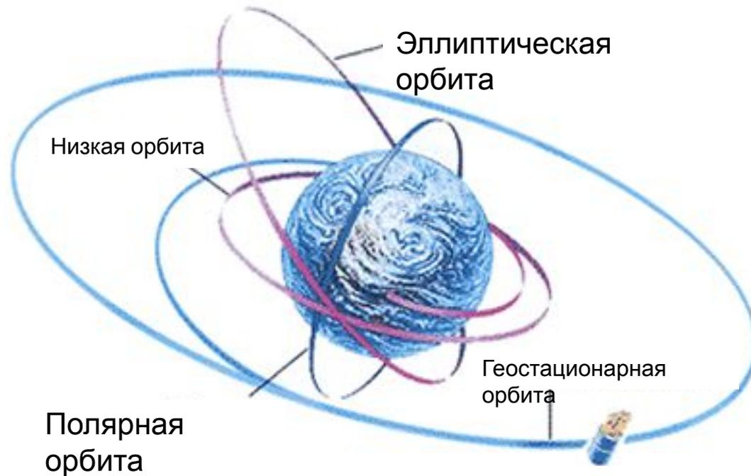
**Низкая околоземная орбита** – на высоте 160 км – 88 мин., на высоте 2000 км – 127 мин.;
