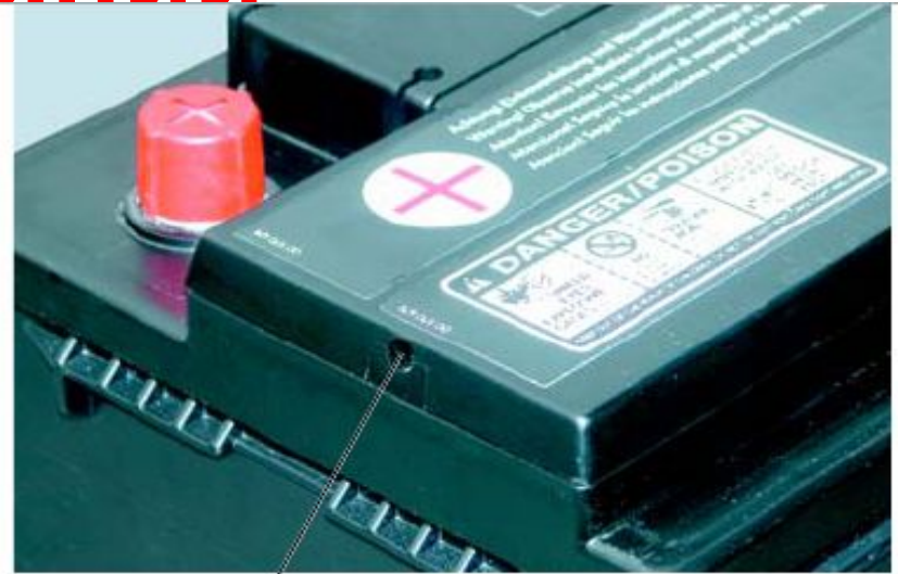
Отверстия центральной системы вентиляции
