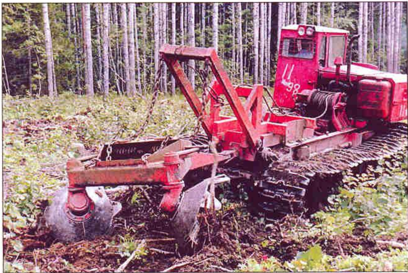
Рис. 6. Обработка почвы полосами с помощью дисковой бороны ТТС-20, агрегатированной с трактором ТЛТ-100. (фото А.И.Соколова)
