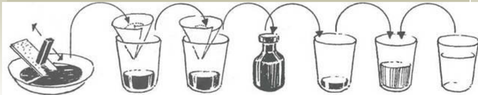
Рис. III.3.5. Подготовка базового и рабочего растворов китайской туши для отмычки
