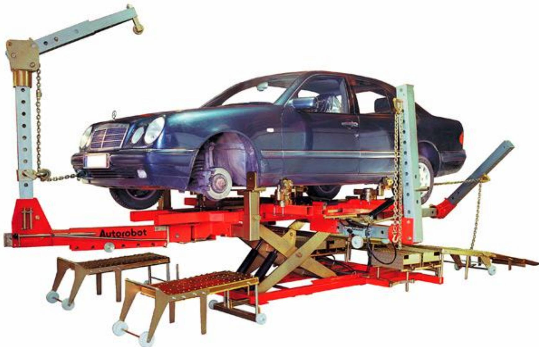
Специализированное оборудование для ремонта кузовов.
