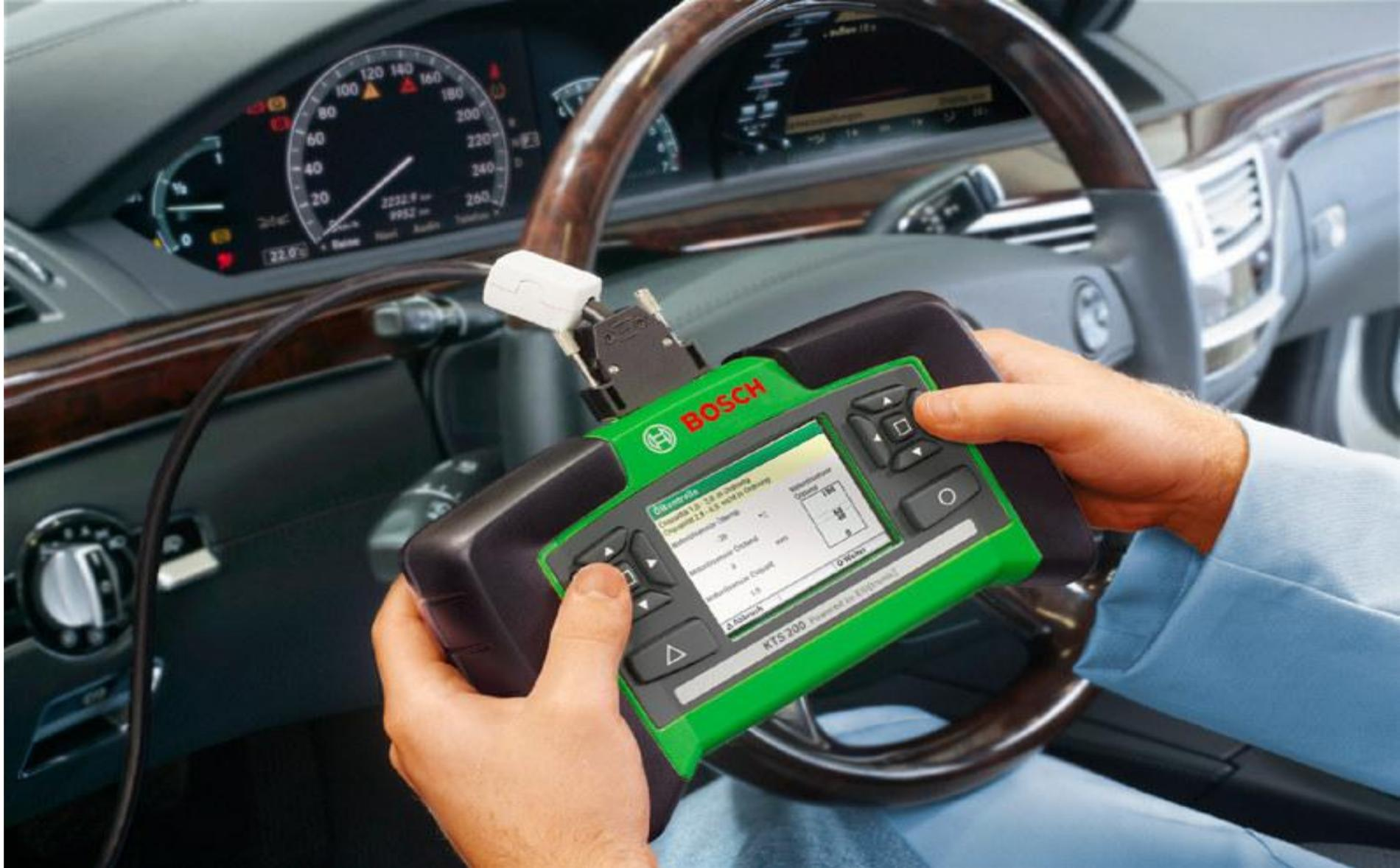
Смешанное оборудование, часть которого располагается на автомобиле (бортовые датчики, накопители информации), а часть вне его — для съема и анализа информации.
