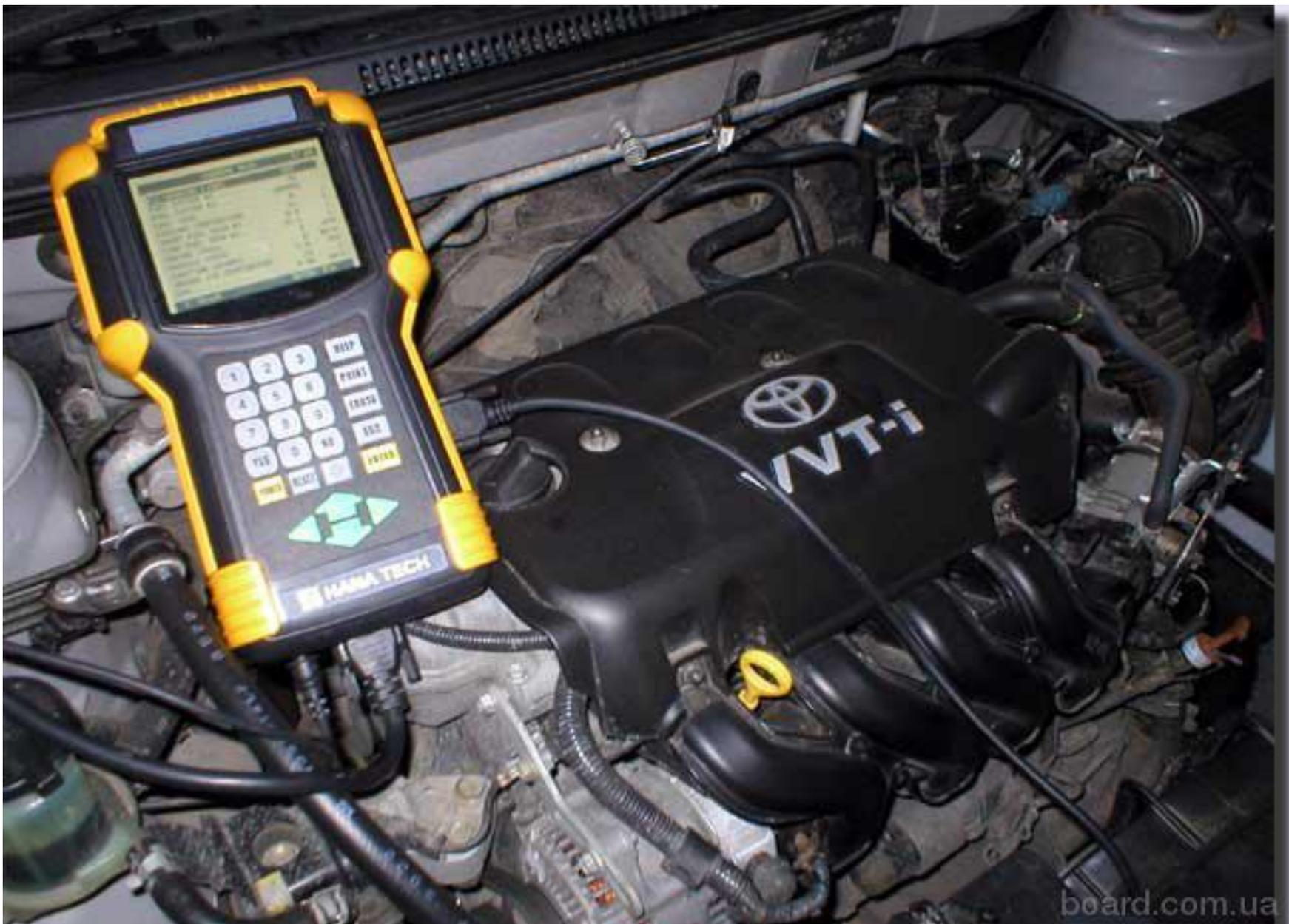
Внешнее оборудование для периодического контроля состояния двигателя
