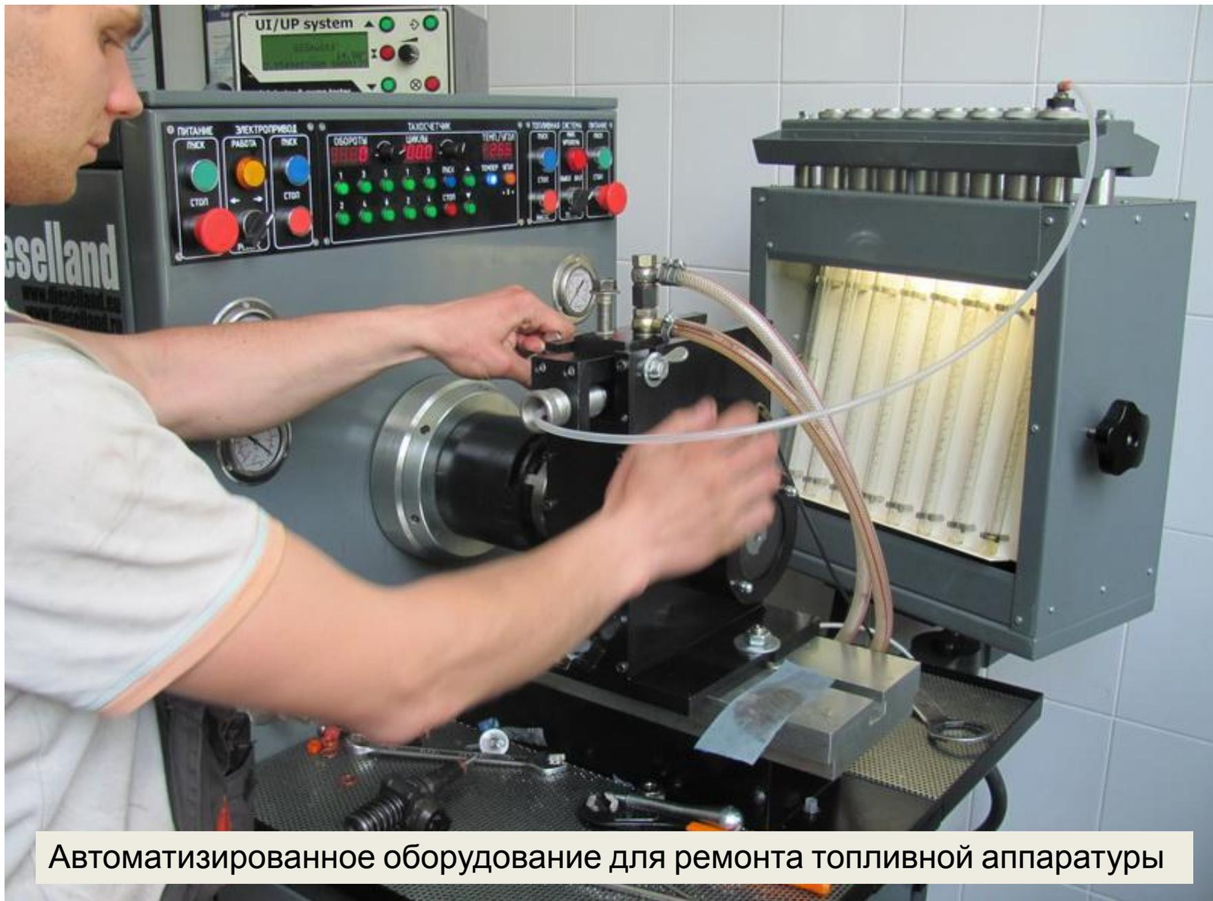
Автоматизированное оборудование для ремонта топливной аппаратуры
