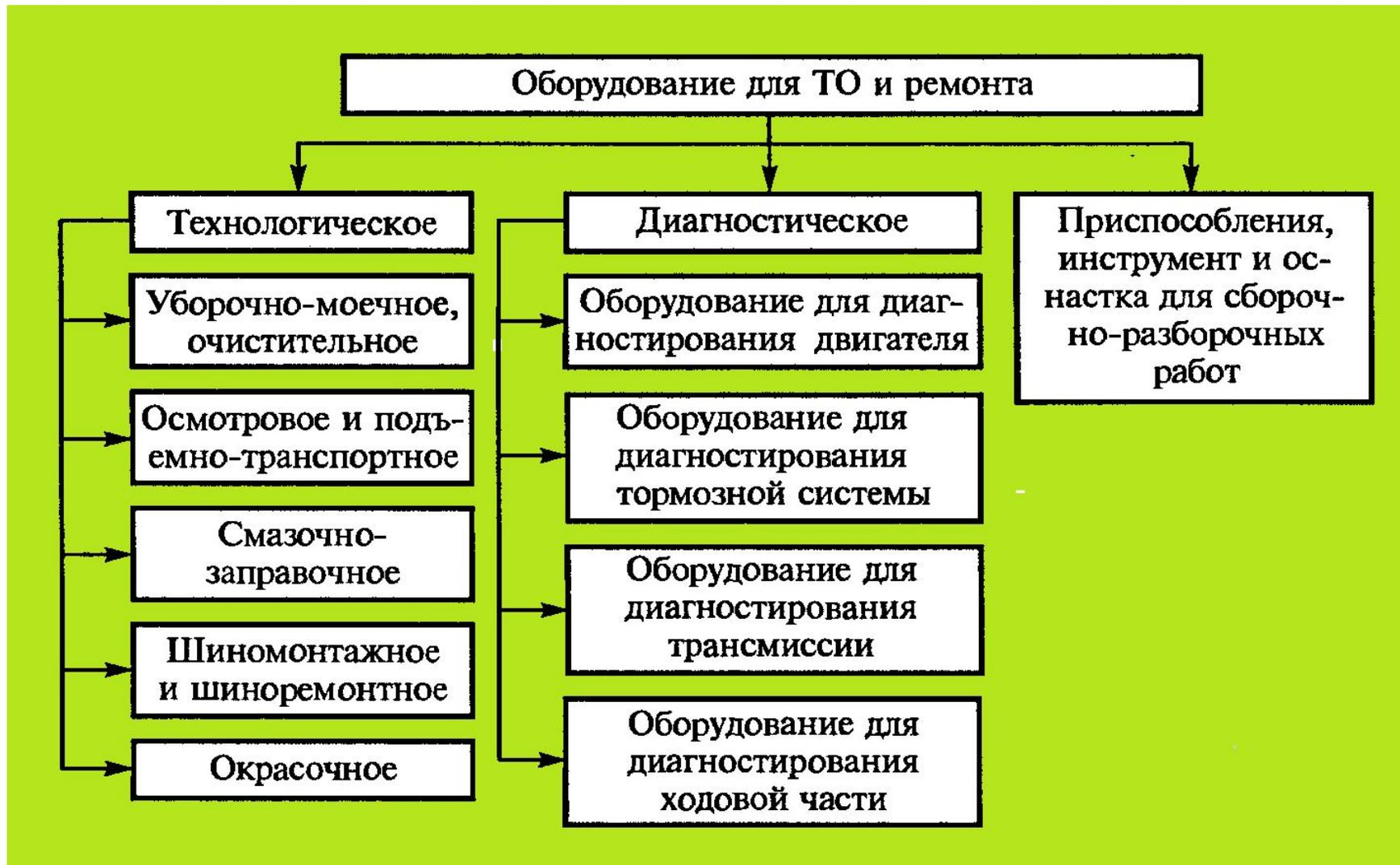
Рис. 11.1. Функциональное назначение оборудования для ТО и ремонта
