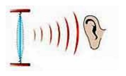
Звуковыми волнами принято называть волны, воспринимаемые человеческим ухом. Диапазон звуковых частот лежит в пределах приблизительно от 16 Гц до 20 кГц.
