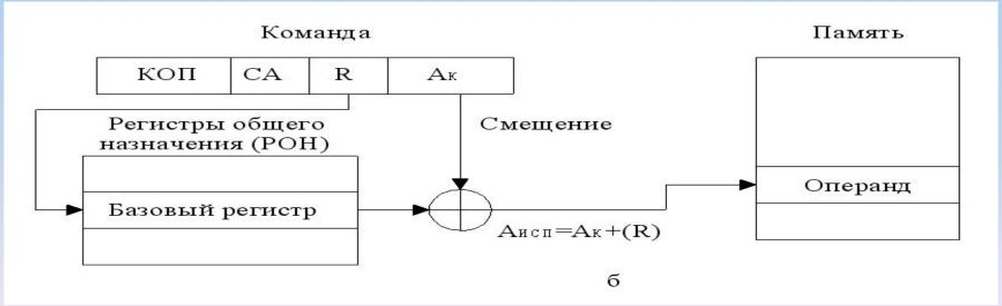
Базовая регистровая адресация: а- с базовым регистром; б – с использованием одного из РОН
