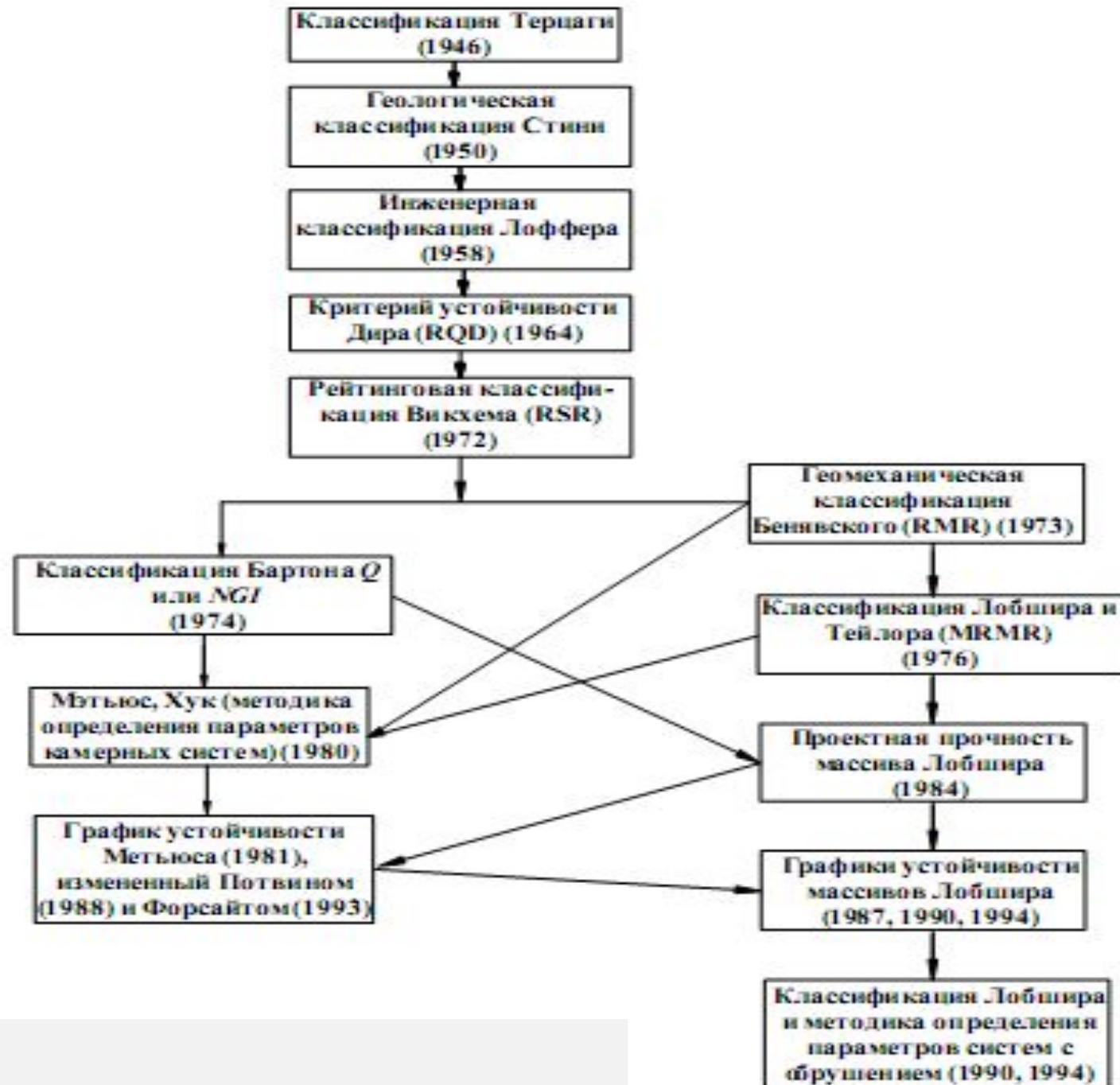
*Классификации массивов являются основой эмпирического подхода к проектированию различных сооружений в скальных массивах, и нашли в этой области широкое распространение. Инженеры предпочитают численные значения качественным описаниям, и поэтому количественные классификации являются полезными при проведении изысканий и проектировании горных работ.*
